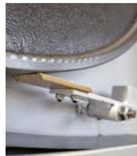
Raschiatori di pulizia in bronzo. Bronze cleaning scrapers.
