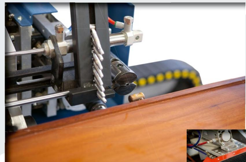
Dettaglio mandrino avvitatore e magazzino cerniere anuba.
